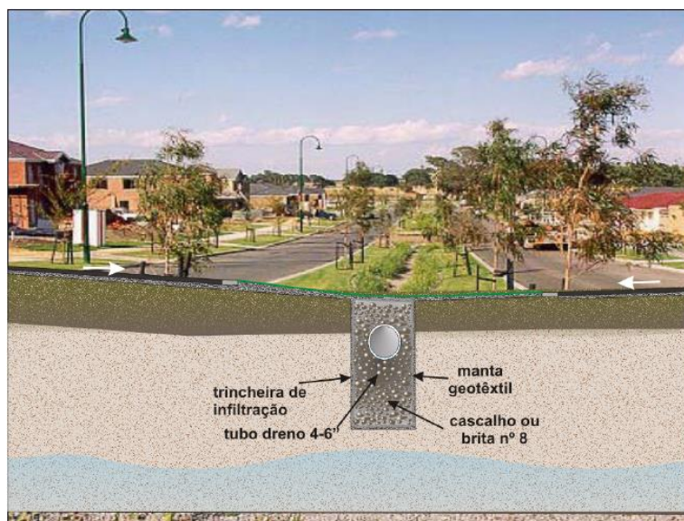
Figura 12. Corte da trincheira de infiltração em canteiro central.
